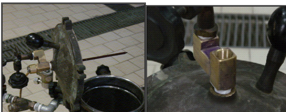
Figura 1 - Tampo da autoclave com a adaptação realizada (à esquerda) e detalhe dessa adaptação (à direita).
